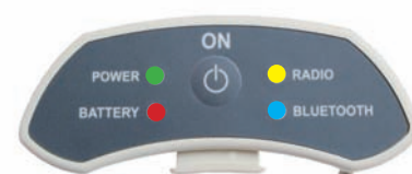
Wskaźniki diodowe informujące o stanie pracy terminala
