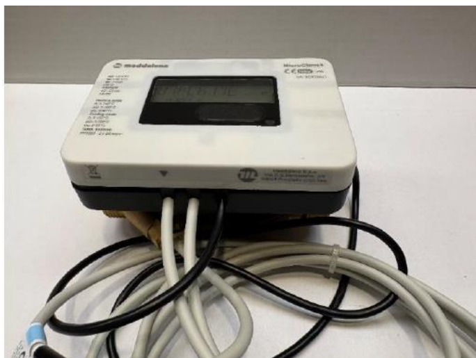
Figure 2 - Meter calculator board without seal Rysunek 2 - Miernik bez plomb założonych na kartę
