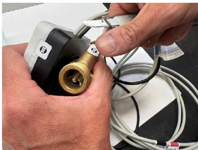
Figure 3- Meter calculator board with seals applied Rysunek 3 - Miernik z plombami założonymi na kartę
